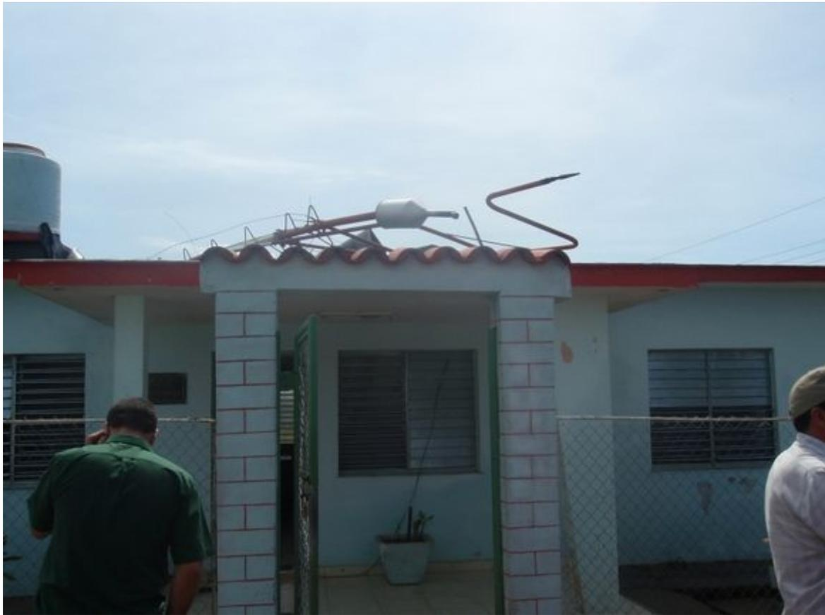
*El mástil y el sensor de medición del anemómetro Dines tumbado en el techo de la estación meteorológica de Paso Real de San Diego, después de ser derribado por la racha máxima de 340 km/h. Foto: José Rubiera.*
