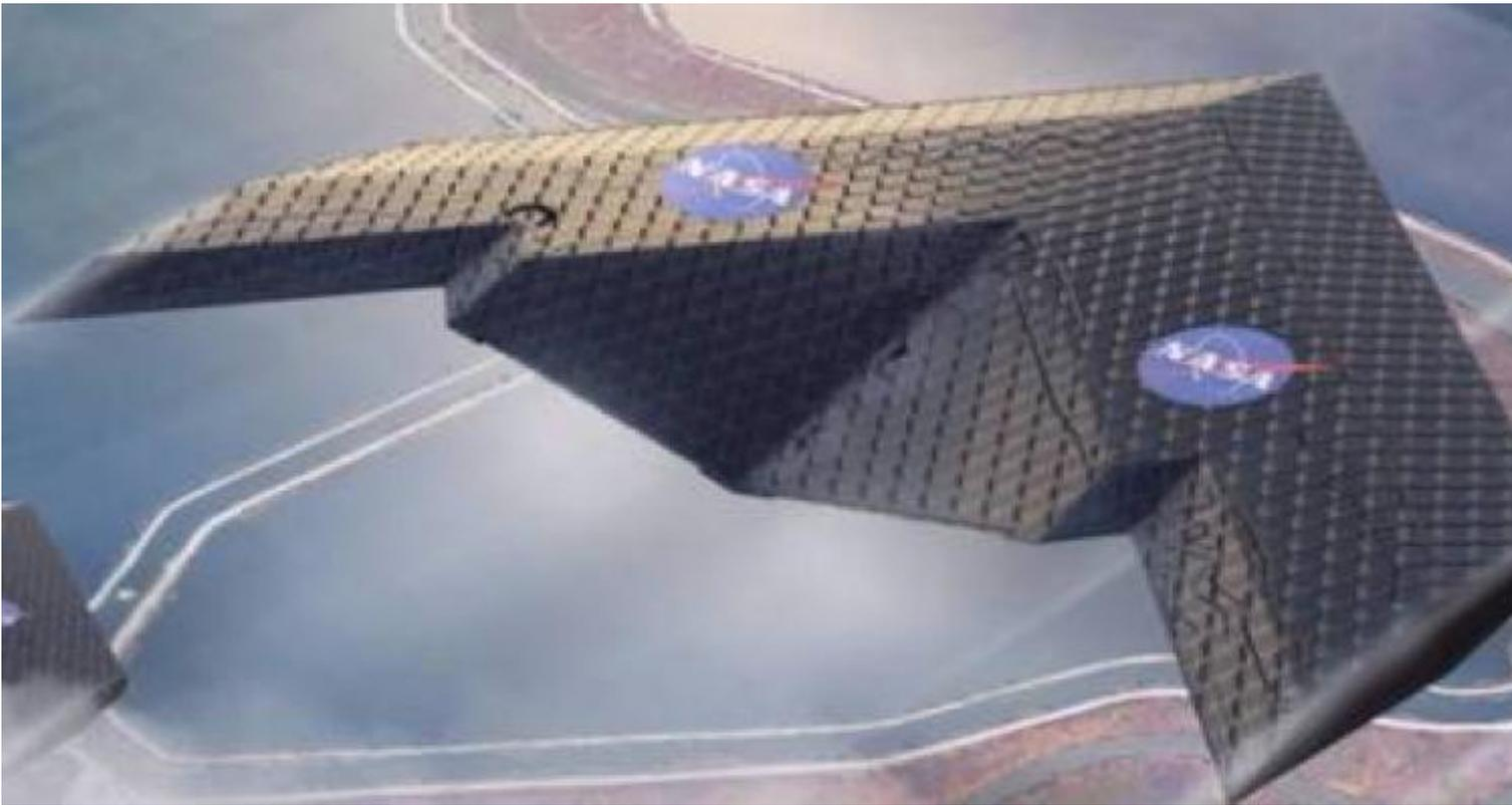
El Instituto Tecnológico de Massachusetts -MIT-, ha construido y probado junto a ingenieros de la NASA un tipo de ala de avión radicalmente nueva, ensamblada a partir de cientos de diminutas piezas, capaz de cambiar de forma durante el vuelo para controlar las maniobras de la aeronave, informa el diario español El País.
