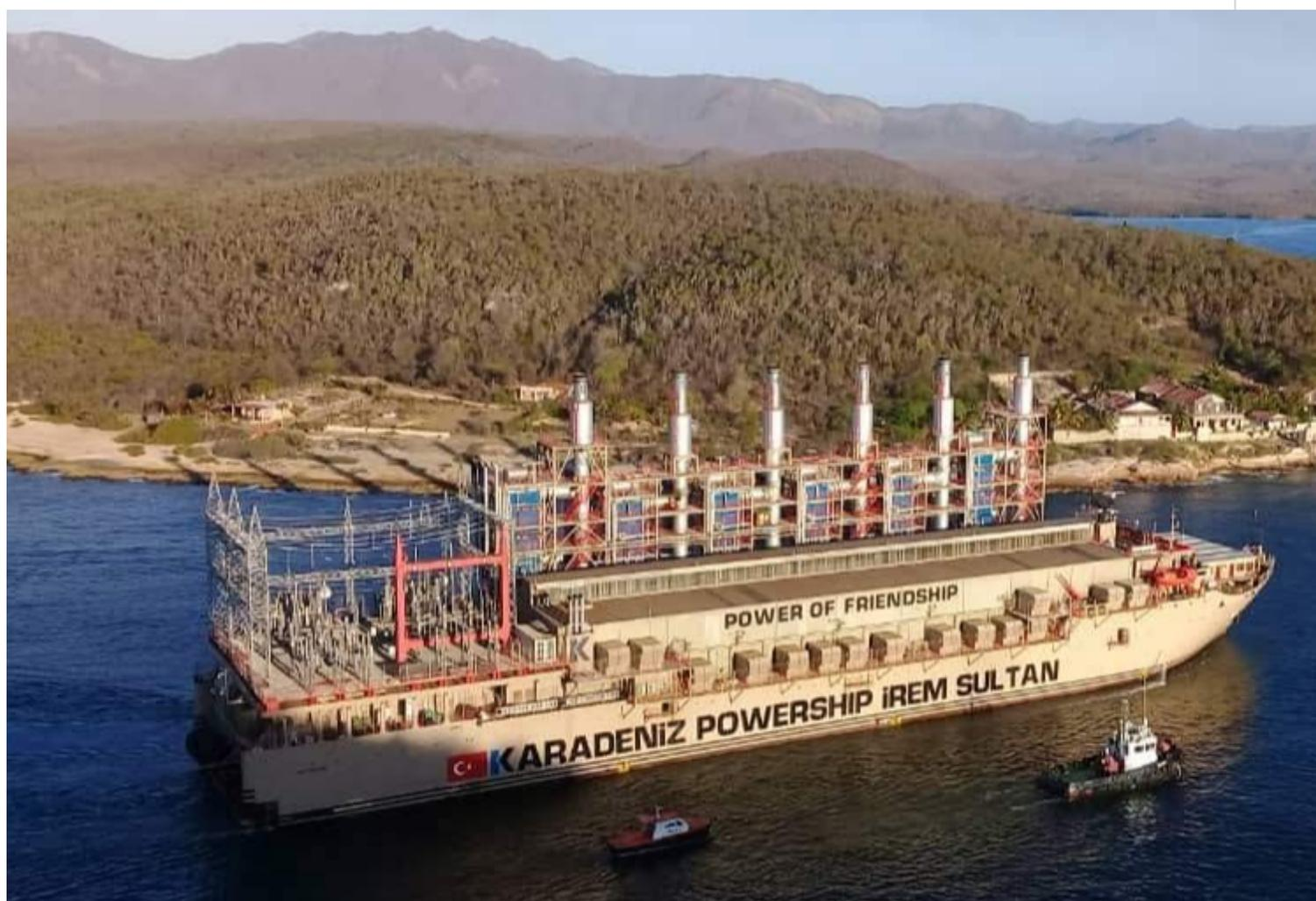
**Cette centrale, une fois raccordée au réseau électrique , devrait fournir entre 100 et 105 MW. Photo Prensa Latina**
